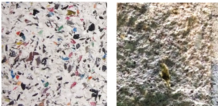
FIG. 5.2. (Izquierda) paneles de yeso con agregados de residuos plásticos de cables. (Derecha) mortero de cemento con residuos de lanas minerales (Fuente: fotos por A. Vidales Barriguete, 2020)
