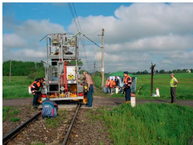
4. Na pierwszym planie – ustawianie pojazdu 4'AXE na tory pod Białymstokiem; w głębi widoczny jest namiot ze stanowiskiem generatora udarowego
