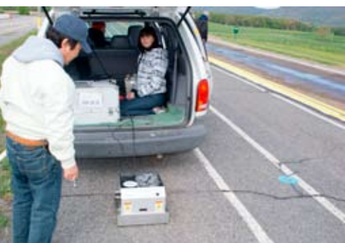
Pomiar makrotekstury urządzeniem CTMeter ( The Larson Institute's test track )
