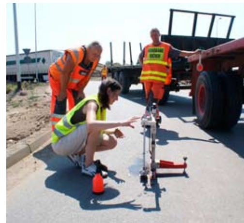
fot. 1. Pomiar właściwości drogowych wahadłem angielskim
