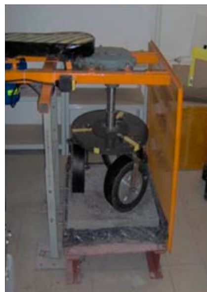
Stanowiska badawcze do oceny właściwości przeciwpoślizgowych kruszywa i nawierzchni drogowych: góra – aparat do przyspieszonego polerowania, dół – polerka płytowa
