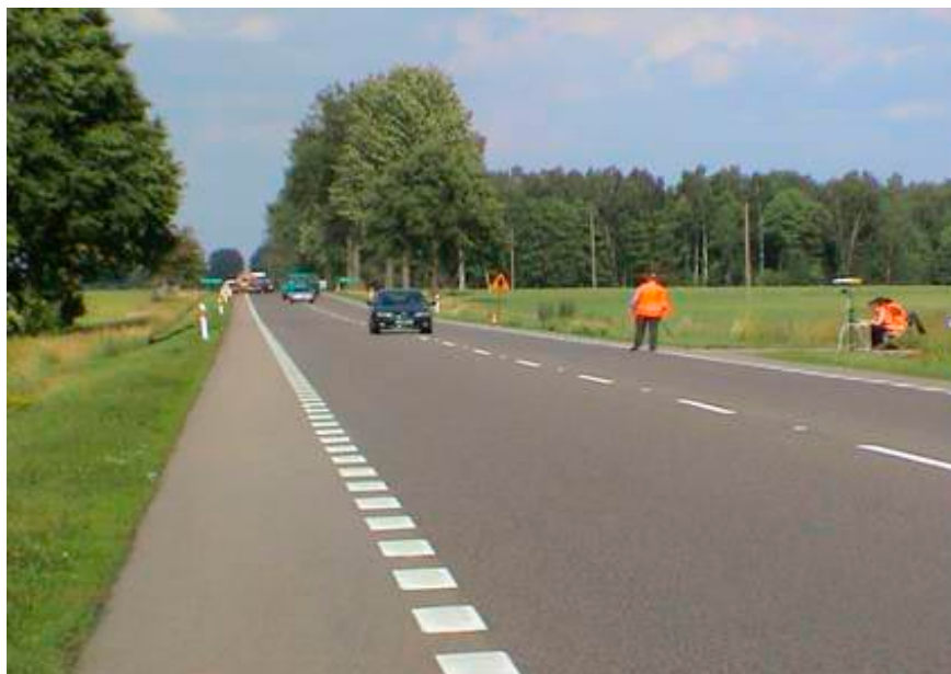
Pomiar poziomu hałasu toczenia metodą kontrolowanego przejazdu (CPB)
