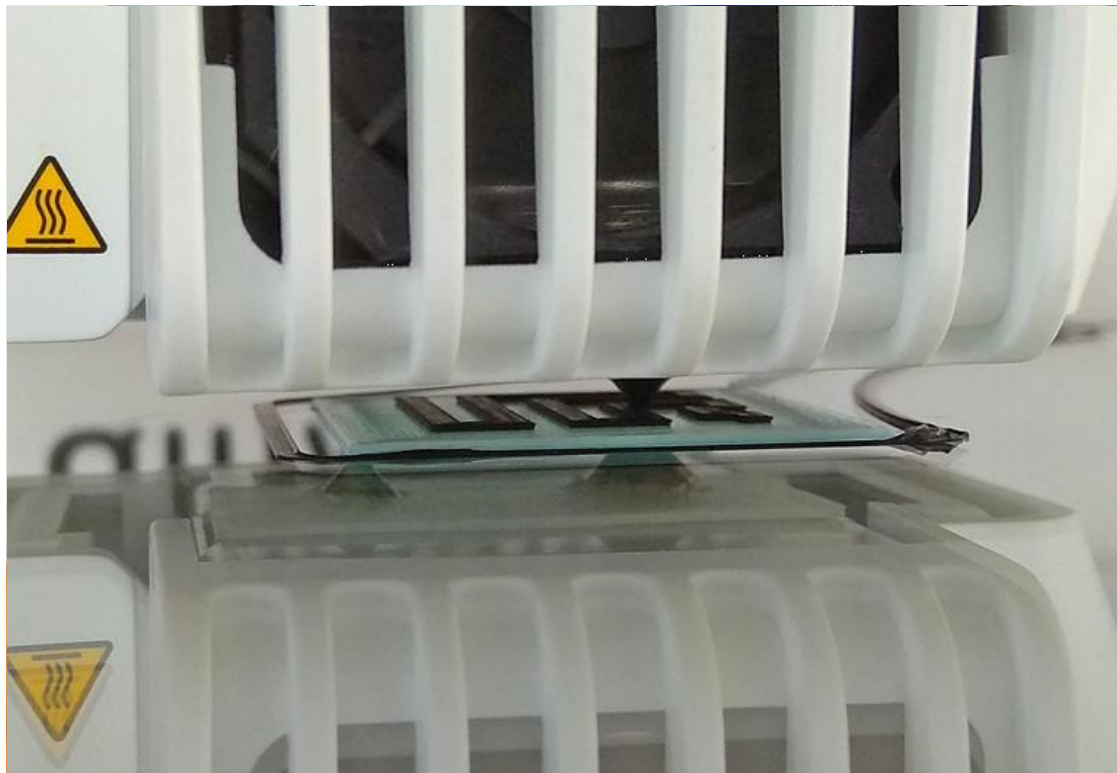
Rys. 5. Etapy druku czujnika przy użyciu Ultimaker 3
