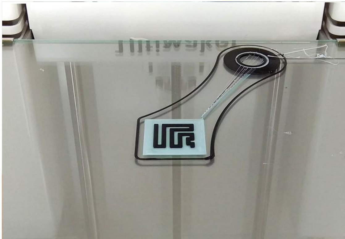
Rys. 5. Etapy druku czujnika przy użyciu Ultimaker 3
