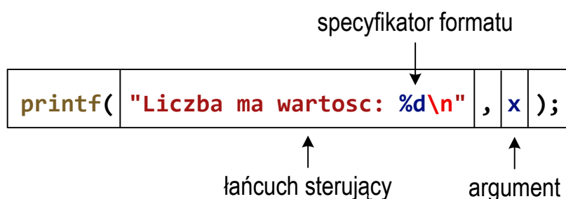
Rys. 2. Struktura funkcji printf()
