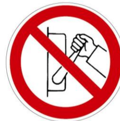
zakaz uruchamiania maszyny, urządzenia
