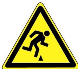
ostrzeżenie przed niebezpieczeństwem potknięcia się
