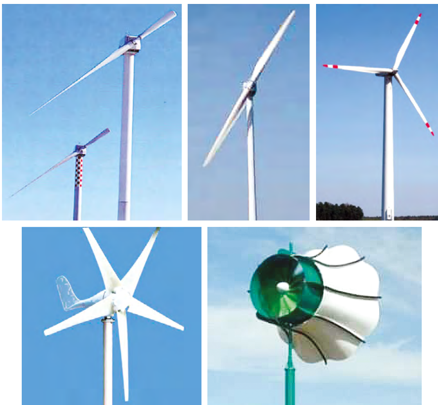
RYS. 1. Przykłady turbin wiatrowych o poziomej osi obrotu: jednoplątowej, dwupłatowej, trzypłatowej, wielopłatowej oraz turbiny z dyfuzorem [3]
