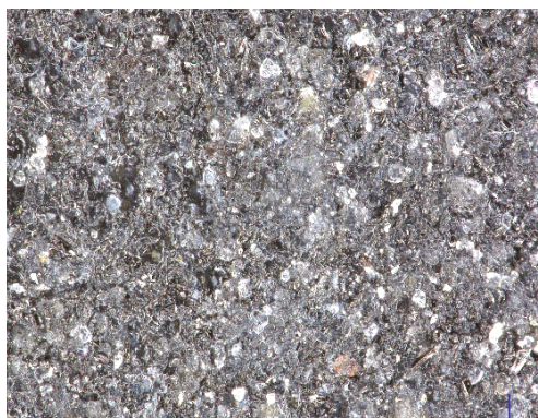
RYSUNEK 9.42B. Kruszywo utwardzane w 20°C, po karbonatyzacji (środek)
