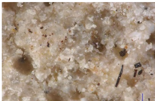
RYSUNEK 9.24C. Widok struktury (środek) kruszywa po obróbce w 300°C, niepoddawanego procesowi przyspieszonej karbonatyzacji
