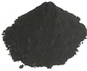
RYSUNEK 7.14. Biokarbonizat drzewny – po lewej fotografia makroskopowa, po prawej obraz w mikroskopie optycznym
