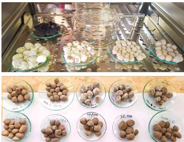
RYSUNEK 9.19. Wykwity węglanowe po zakończonym procesie karbonatyzacji w komorze \text{CO}_2 na kruszowach niewygrzewanych ( 20^\circ\text{C} ) i wygrzewanych w 100 i 200^\circ\text{C} oraz ich brak na kruszowach poddanych działaniu temperatur 300 i 400^\circ\text{C}
