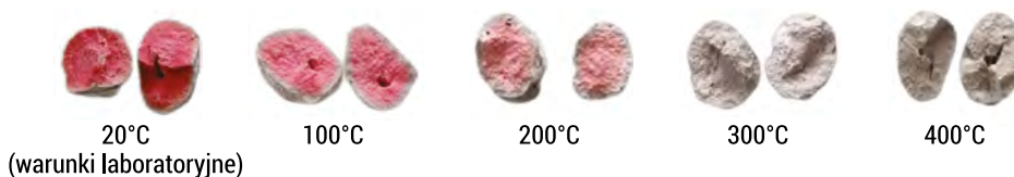
RYSUNEK 9.21. Postęp karbonatyzacji w przypadku kruszyw dojrzewających bez wygrzewania i po obróbce temperaturowej w 100–400°C w wyniku testu fenoloftaleinowego (kruszywo o składzie 80% ZREC, 20% MET)
