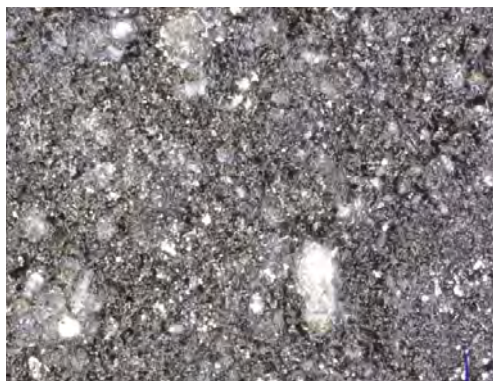
RYSUNEK 9.42C. Kruszywo wygrzewane w 300°C, niepoddane karbonatyzacji (środek)
