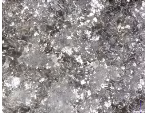
RYSUNEK 9.42D. Kruszywo wygrzewane w 300°C, po karbonatyzacji (środek)
