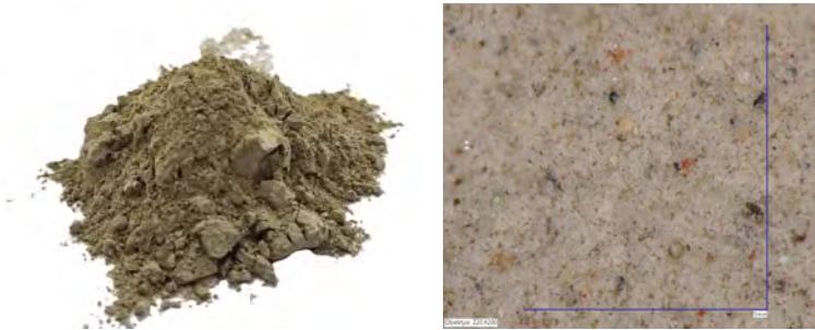
RYSUNEK 7.7. Zaprawa recyklingowa (ZREC_3) przygotowana do dalszych badań – po lewej fotografia makroskopowa, po prawej obraz w mikroskopie optycznym
