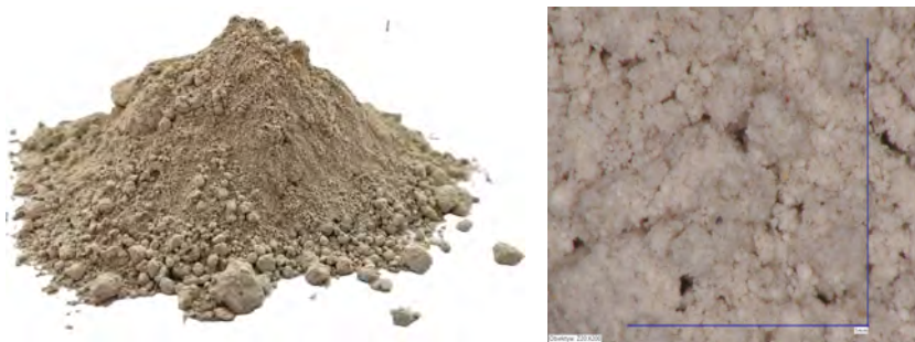
RYSUNEK 7.10. Metakaolin MK-40 ASTRA Polska wykorzystany do produkcji kruszyw – po lewej fotografia makroskopowa, po prawej obraz z mikroskopu optycznego
