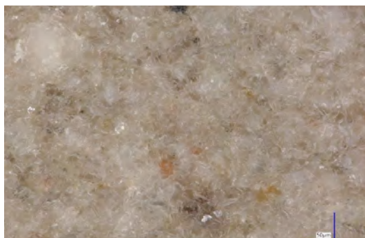
RYSUNEK 9.24D. Widok struktury (środek) kruszywa po obróbce w 300°C, po procesie przyspieszonej karbonatyzacji
