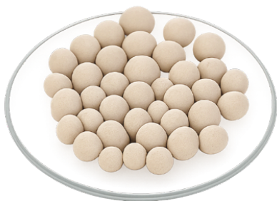
RYSUNEK 9.11. Wytworzone kruszywo sztuczne: a – niewygrzewane (20°C); b – wygrzewane w 300°C
