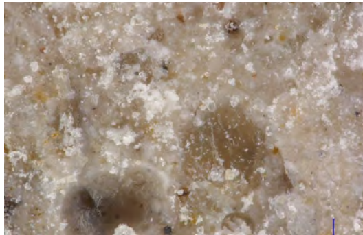
RYSUNEK 9.24A. Widok struktury (środek) kruszywa bez wygrzewania (20°C), niepoddawanego procesowi przyspieszonej karbonatyzacji
