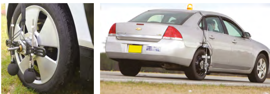
RYSUNEK 2.2. Badania hałaśliwości nawierzchni metodą OBSI
