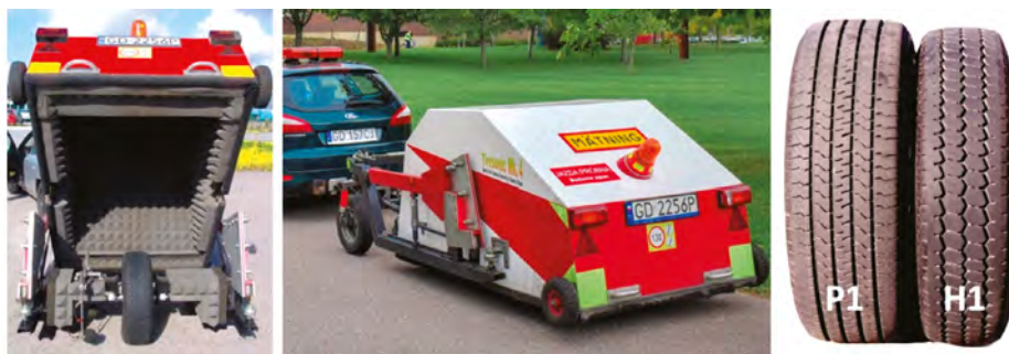
RYSUNEK 2.1. Przyczepa testowa w metodzie CPX oraz dwie referencyjne opony P1 i H1
