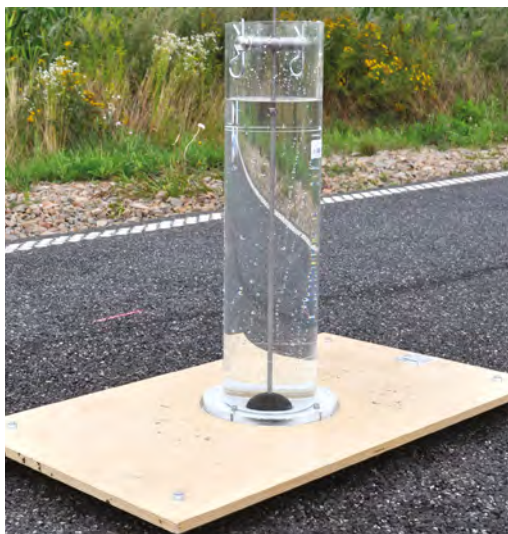
RYSUNEK 2.11. Badania wodoprzepuszczalności: a) urządzenie laboratoryjne; b) urządzenie terenowe
