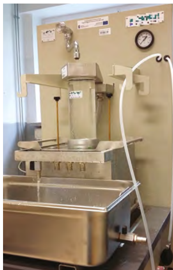
RYSUNEK 2.11. Badania wodoprzepuszczalności: a) urządzenie laboratoryjne; b) urządzenie terenowe
