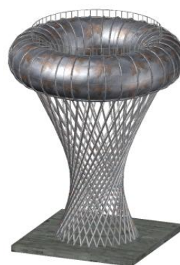
Rys. 6. Modelowanie wieży ciśnień w Ciechanowie w środowisku AutoCAD-a. Źródło: [5]
