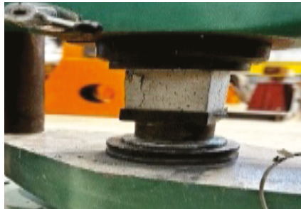
FIG. 2. Compressive strength test on a 100 mm cube (EN 123903)
