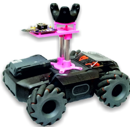
Rysunek 2. Platforma mobilna wraz z lokalizatorem Wi-Fi i HTC Vive Tracker 3.0 Źródło: opracowanie własne.
