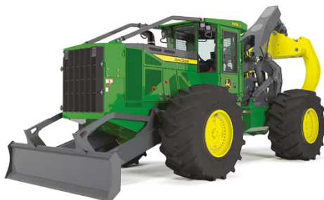
RYCINA 26. Skider – specjalistyczny ciągnik do transportu dłużyc
