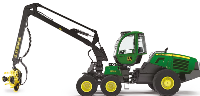
RYCINA 24. Harvester – wielooperacyjna maszyna do pozyskiwania drewna kładowanego
