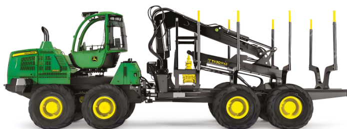
RYCINA 25. Forwarder – samozaładowczy ciągnik leśny
