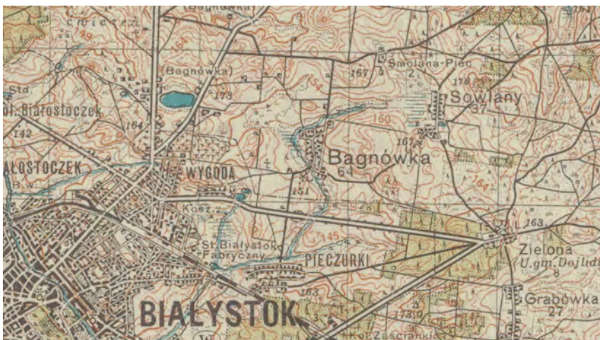
Rysunek 6.12: Fragment mapy Białegostoku sprzed II wojny światowej – ukształtowanie terenu charakteryzują warstwyce główne narysowane grubą linią i numerowane liczbami wysokościowymi (cechami) oraz warstwyce podrzędne, których wysokości można wyznaczyć poprzez interpolację
