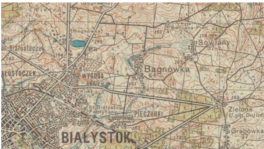
Rysunek 6.12: Fragment mapy Białegostoku sprzed II wojny światowej – ukształtowanie terenu charakteryzują warstwy główne narysowane grubą linią i numerowane liczbami wysokościowymi (cechami) oraz warstwy podrzędne, których wysokości można wyznaczyć poprzez interpolację
