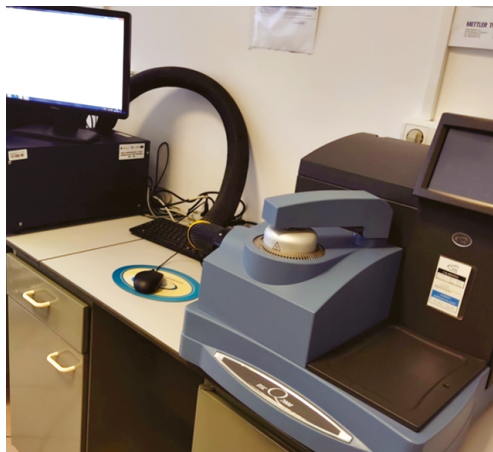
RYS. 6. Różnicowy kalorymetr skaningowy (DSC)
