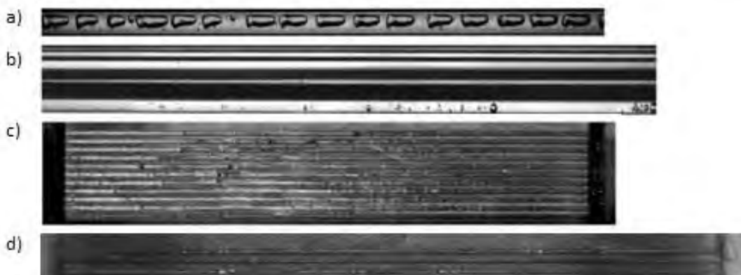
Rysunek 1: Przykłady klatek filmu zarejestrowanych w trakcie przepływu dwufazowego: a) roztworu wodnego gliceryny i powietrza w okrągłym minikanale, b) z wrzeniem w dwóch okrągłych minikanalach, c) z wrzeniem w 11 równoległych mikrokanalach, d) z wrzeniem w trzech prostopadłościennych minikanalach
