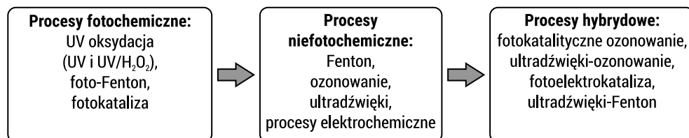
RYC. 1.9. Typy procesów stosowanych do degradacji farmaceutyków w ściekach
