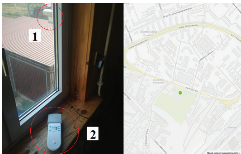
Rysunek 1. a) stanowisko pomiarowe, gdzie: 1 – czujnik zewnętrzny Airly (zamontowany na elewacji, przy oknie), 2 – miernik wewnętrzny Aeroqual; b) lokalizacja domu jednorodzinnego na mapie
