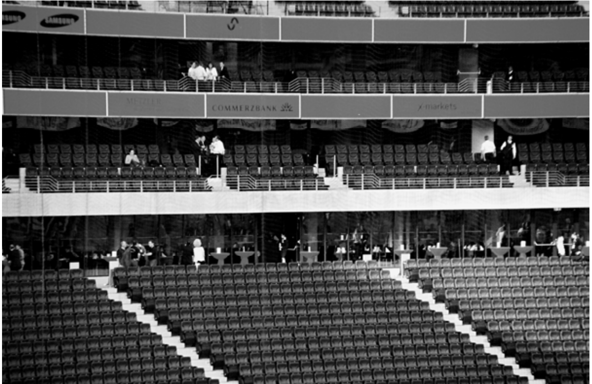
Fot. 1-27. Fragment widowni zachodniej Commerzbank Arena we Frankfurcie. Trzy poziomy miejsc specjalnych, zaprojektowanych pomiędzy widownią dolną i górną. Na najniższym poziomie umieszczono restaurację z tarasem wyeksponowanym na wnętrzu stadionu, dwa wyższe poziomy stanowią ciąg indywidualnych łóż z zapleciami.
