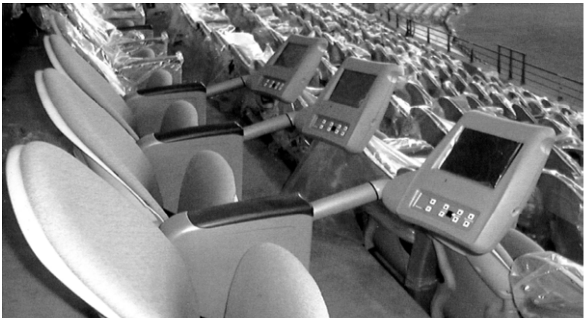
Fot. 1-43. Colonial Stadium w Melbourne. Przykład poszukiwania rozwiązań podnoszących komfort indywidualnego miejsca na widowni stadionowej. Na trybunach stadionu zamontowano tysiąc foteli wyposażonych w interaktywne pulpity połączone z centralnym serwerem stadionowej sieci komputerowej oraz z internetem. Pulpity umożliwiają podgląd obrazu transmisji telewizyjnej oraz różne sekwencje wykorzystania tego obrazu (cofanie, zwalnianie, powtarzanie, powiększanie itp.). System ten zapewnia ponadto łączność z dystrybutorami usług adresowanych do widzów, jak np. usługi kulinarne. Umożliwia też dostęp do pakietów informacyjnych związanych z danym widowiskiem, jak również zewnętrzną łączność komunikacyjno-informacyjną.
