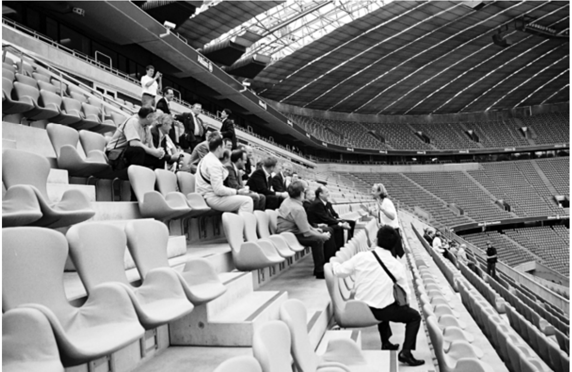
Fot. 3-3. Allianz Arena, Monachium (2006) – fragment drugiego piętra trybun zachodnich. Zdjęcie uwidacznia relacje przestrzenne pomiędzy stałymi elementami widowni i ich użytkownikami – widzami rozmieszczonymi w poszczególnych rzędach. W górnej części obrazu widoczny system velarów umożliwiający kontrolowanie stopnia nasłonecznienia areny i widowni. Foto: M. Pelczarski.
