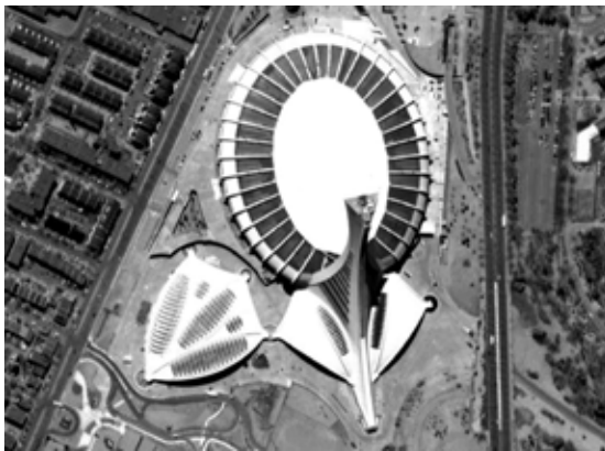
Fot. 1-12. Stadion Olimpijski w Montrealu (1976, 1986). Śmiała koncepcja otwieranego nad areną przekrycia – podwieszonego na kablach nośnych do wierzchołka wieży (175m). Otwieranie dachu odbywało się poprzez podciąganie kevlarowej membrany po linach nośnych do góry i magazynowanie jej w szczycie wieży. Stadion przeszedł do historii architektury jako arcydzieło żelbetowej architektury organicznej.
