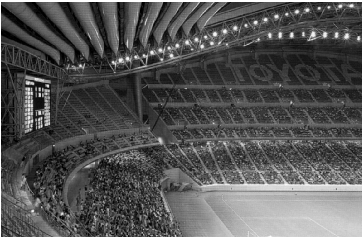
Fot. 4-9. Stadion Toyota, miasto Toyota. Przykład widowni o gęstym układzie schodów południkowych. Szerokość sektorów ograniczono do 14 miejsc w rzędzie, co jest charakterystyczne dla wszystkich japońskich stadionów przygotowanych na Mistrzostwa Świata w Piłce Nożnej Japonia-Korea 2002. Jest to efekt zastrzonych przepisów bezpieczeństwa, wynikających z zagrożeń wystąpienia trzęsień ziemi.
