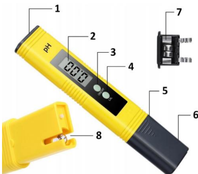
Rys. 3. Budowa miernika pH
